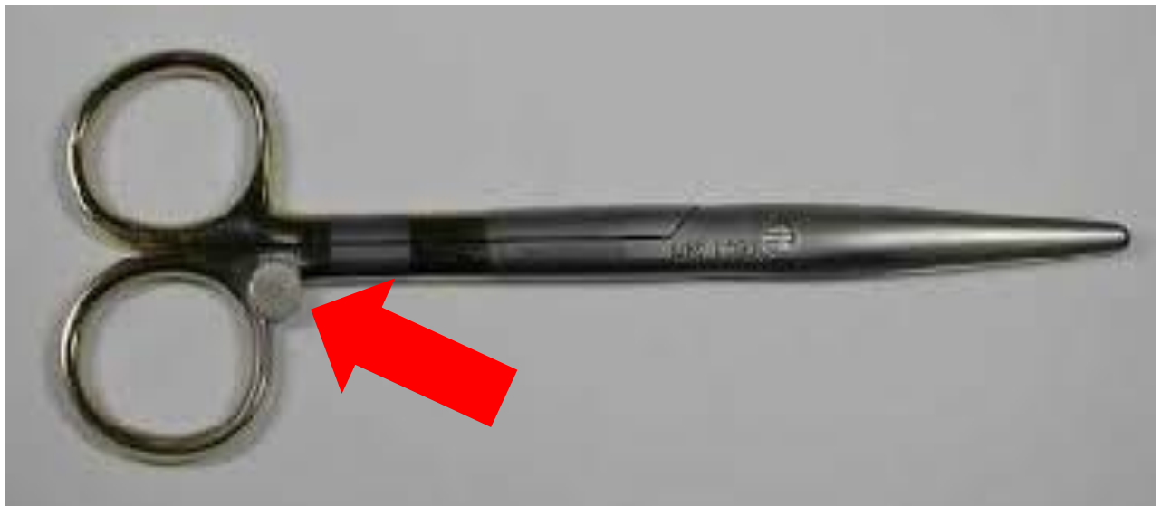
Figure 48: Puce RFID fixée sur un DM
